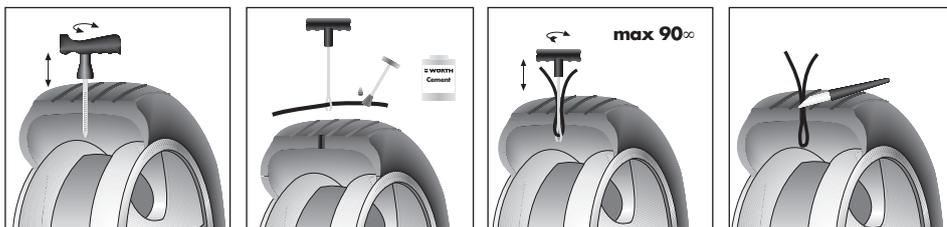
Estrarre l'oggetto che ha causato la perforazione e alesare con l'apposito utensile il canale lungo l'angolo di perforazione.
